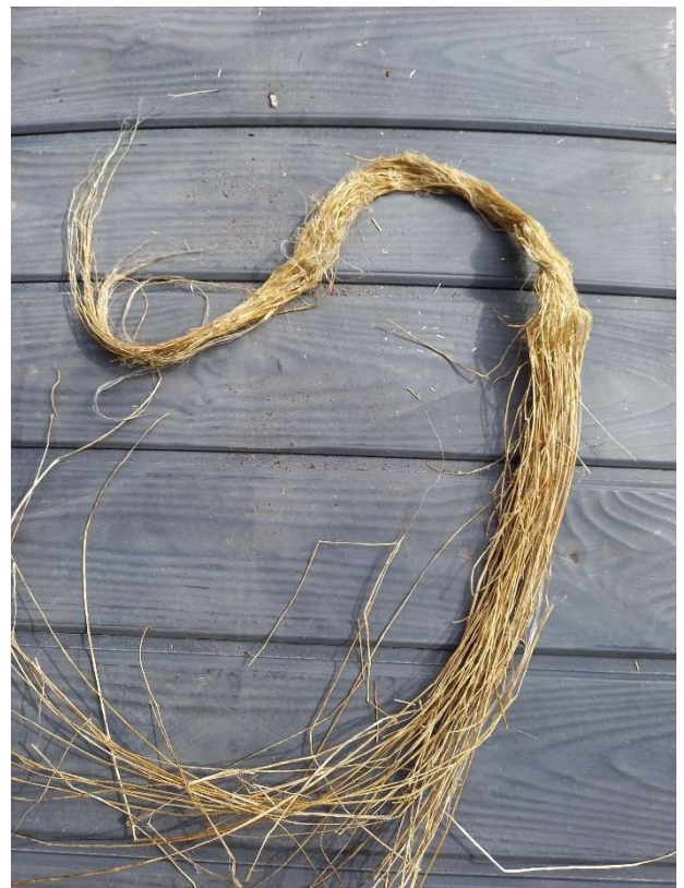
Gedeeltelijk bewerkt vlas. De houtachtige delen van het gedroogde vlas worden verwijderd voordat het spinnen kan beginnen - een arbeidsintensief proces van braken, zwingelen en kammen. Foto en tekst: Anne Wijngaard, 2025.
