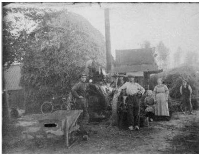
Dorsmachine met locomobiel 7 .
